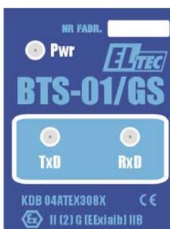
Rys. 3a. Tabliczka znamionowa bariery transmisyjno sygnałowej BTS-01/GS.
